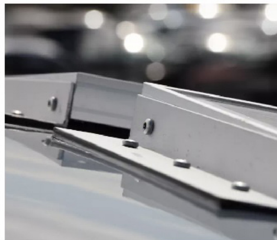
Modellspecifika fästen möjliggör fasta paneler på pop-up-versionens välvda tak.
