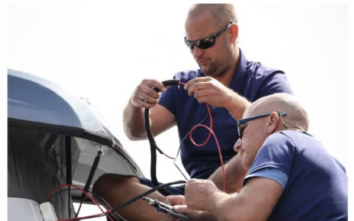
Vattentät kabeldragning. För att göra så få ingrepp som möjligt återanvänds kabellister och kopplingsboxar (fast nu utan sockerbitar).
