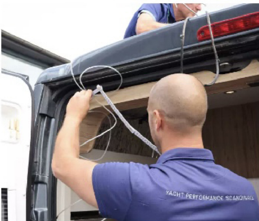
Utmanande kabeldragning där inner-tak och inredning ställer till det.
