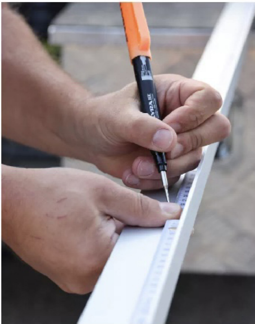
För att kunna montera fasta paneler på det välvda pop-up-taket behövde Joel Nordahl på YPS tillverka modellspecifika fästen ...
